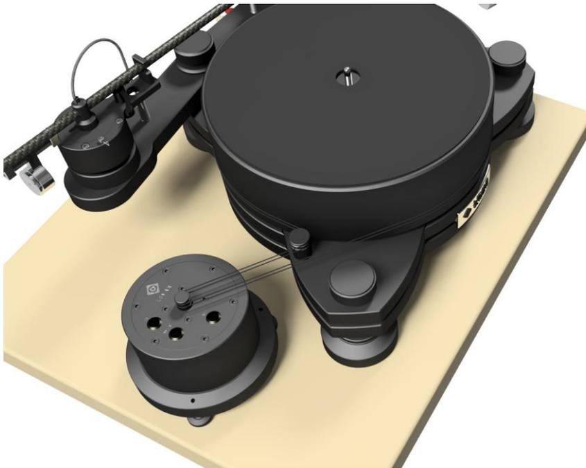
Stecken Sie den Schaft des Tonarms in die Klemmbasis am Ausleger. Klemmen Sie diese mit den beiden Stiftschrauben M6. Richten Sie dabei die Tonarmablage passend zum Laufwerk aus. Achten Sie darauf, dass der Tonarm, wenn er von der Auflage entnommen wird, auf der Plattenaußenkante zum Aufliegen kommt. Somit ist sichergestellt, dass der Arm nicht aus Unachtsamkeit daneben fallen kann.
