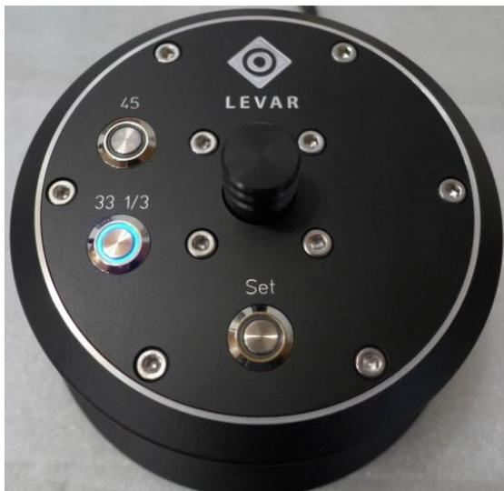
Zum Anwählen der Geschwindigkeit 33,3 U/min den LED-Taster mit der Beschriftung "33  $\frac{1}{3}$ " durch einmaliges Drücken betätigen. Die weiße Taster-LED leuchtet auf und der Antriebsmotor beginnt sich zu drehen. Durch den implementierten Softstart erreicht der Motor erst nach einigen Sekunden seine volle Drehzahl.
