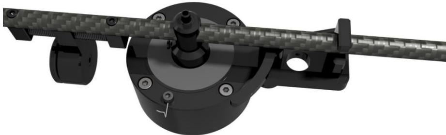
Entnehmen Sie das Headshell vom Armrohr und setzen darin das Tonabnehmersystem ein. Sollte es sich um ein eher leichtes System handeln (<8 g) können Sie mit dem beiliegenden Frontgewicht die vordere Gewichtsmasse erhöhen. Verwenden Sie zum Befestigen die beiliegenden schwarzen Schrauben. Verbinden Sie die Kabel farbenrichtig mit den Pins des Tonabnehmersystems. Es empfiehlt sich die Verwendung eine Spitzzange oder stabilen Pinzette.
